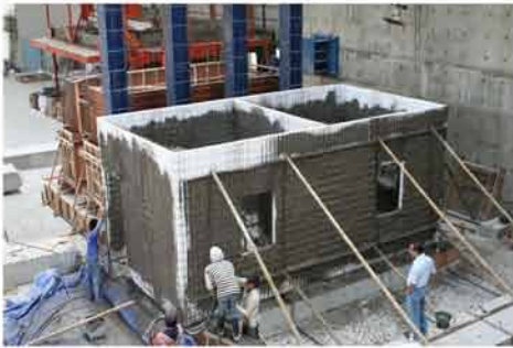
Uji gempa bangunan b-panel® di PUSLITBANGKIM Cileunyi (Simulasi gempa zona-6 Indonesia)
